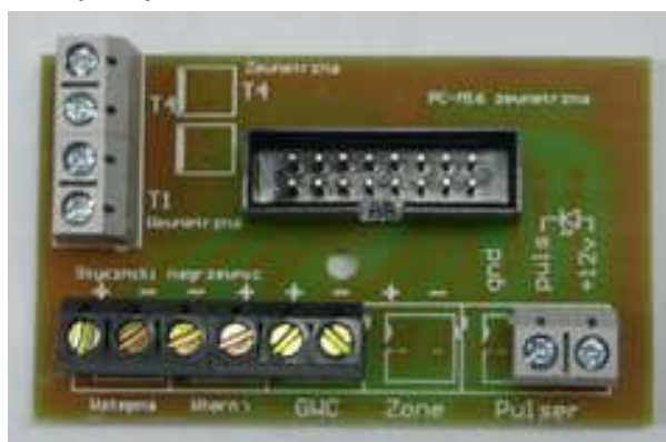
Rys. 5.4.2 Widok płytki zewnętrznej sterownika M16 (PC-M16 zewnętrzna).
